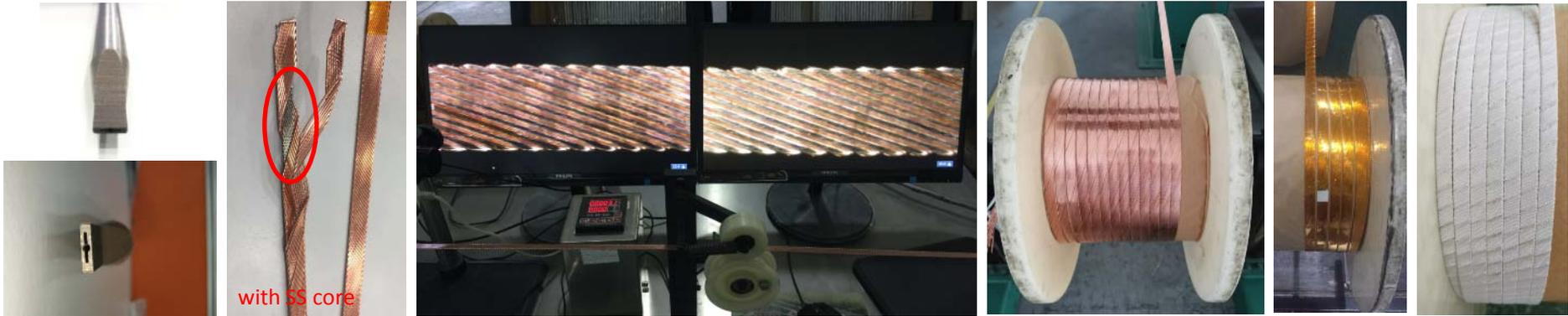
在无锡统力电工完成卢瑟福电缆的绞制,绞制20芯铌三锡缆约125米; 31芯铌钛缆约205米; 铜缆共约250米
